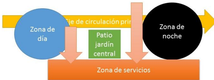
Fig. 5. Esquema de zonificación, donde se aprecia el eje de circulación principal que cursa toda la residencia y los ejes axiales que conducen a la zona de servicio, alimentando la zona de día y la zona de noche.
